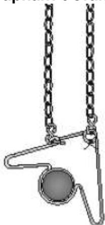
Для угла подвески в 45 градусов, используйте два S-образных крюка и две двухконтурные цепи №1.
