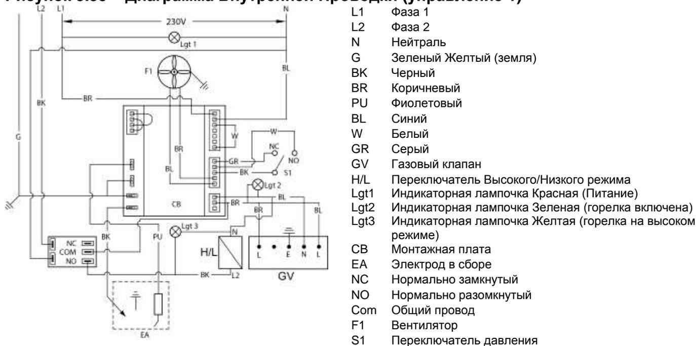
**Рисунок 3.34 – Диаграмма Внутренней Проводки (управление 2)**
