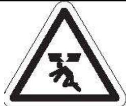
Неправильная подвеска обогревателя может привести к его падению и поломке. Всегда подвешивайте прибор к постоянной части конструкции здания, которая сможет выдержать общий вес и силу обогревателя
